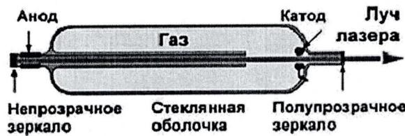
Процесс перекачки энергии внешнего источника в рабочую среду газового лазера производится за счет:
